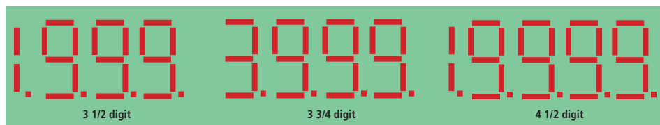
4. De toegepaste display is bepalend voor de mogelijkheden en meetnauwkeurigheid van de multimeter. Belangrijk om op te letten bij de aanschaf van een multimeter. Hier zie je drie voorbeelden.
