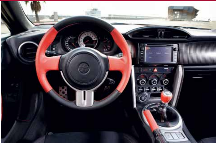
Cockpit in race-stijl, met zeer prominente toerenteller die bij sportief rijden erg van pas komt om te controleren of de toeren hoog genoeg liggen voor volle trekkracht. In de toerenteller zit ook een digitale snelheidsmeter.
