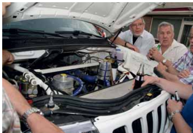
De motor is van BMW. Het is een drieliter zescilinder met 306 pk. Oorspronkelijk heeft de motor twee turbos, maar deze zijn vervangen door één grote. Daarmee levert de motor 700 Nm en sprint hij in 7,8 seconden naar 100 km/u.
