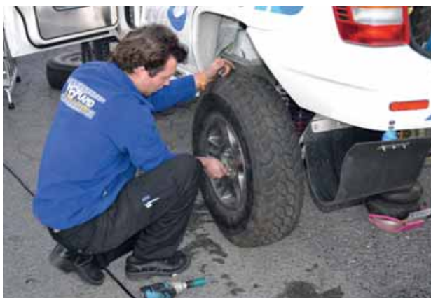
Tijdens de Africa Eco Race reed het Hofland Rally Team op banden van Toyo en BF Goodridge. De Toyo banden zijn hard en geschikt voor het rijden over stenen. BF Goodridge werd gebruikt in de zandduinen. Met een lage bandenspanning rolden ze probleemloos door het zand.
