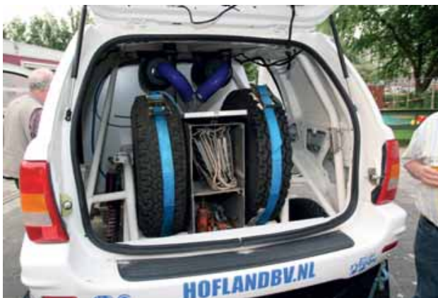
Achter in de auto zitten twee reservebanden en hulpmiddelen om de auto uit te graven. De twee cycloon luchtfilters zorgen voor frisse lucht voor de motor, zonder zandkorrels. Tijdens de rally zijn de filters twee maal vervangen.
