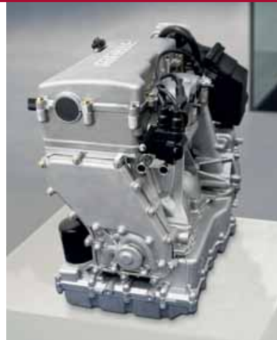
De tweecilinder range extender met generator meet niet meer dan ongeveer 48 bij 42 bij 33 cm.
