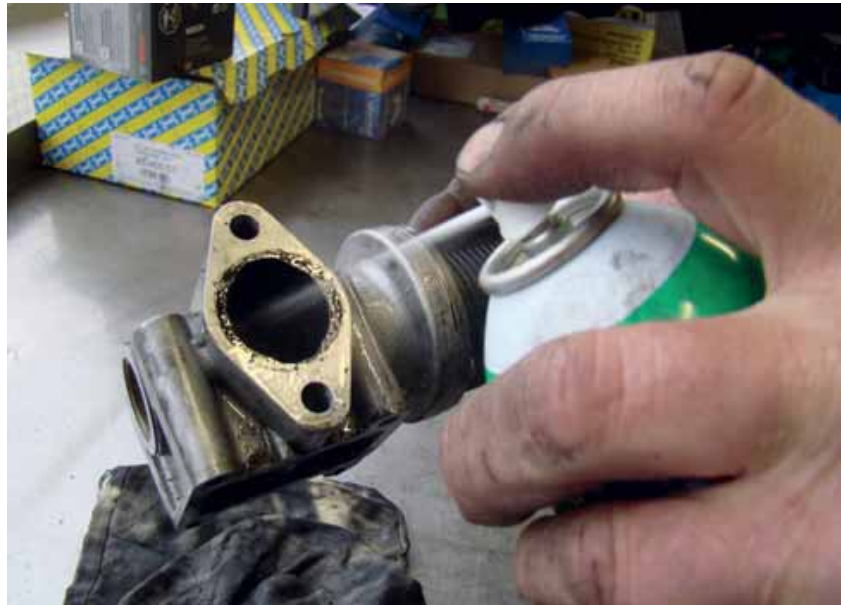
Een klein beetje WD-40 op de afdichting van de EGR-klep bracht aan het licht dat het onderdeel niet goed afslot waardoor het mengsel bij stationair te weinig zuurstof bevatte.
