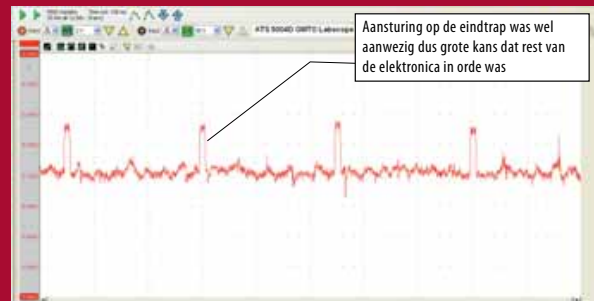
Figuur 4. De eindtrap wordt wel aangestuurd, maar stuurt niets uit. Conclusie: hij is doorgebrand, waarschijnlijk doordat beide draden van het gammele stekkertje op de aircocompressor elkaar geraakt hebben.
