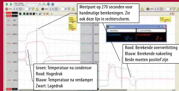
Figuur 2. Meting en automatische berekening van nakoeling en oververhitting. Gastechnisch is de airco in orde.
