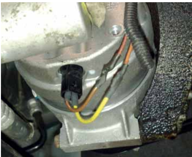
Figuur 1. De airco stopt er steeds na anderhalve minuut mee. Vervanging van de aircocompressor helpt niet. Kan dit stekkertje de oorzaak zijn?
