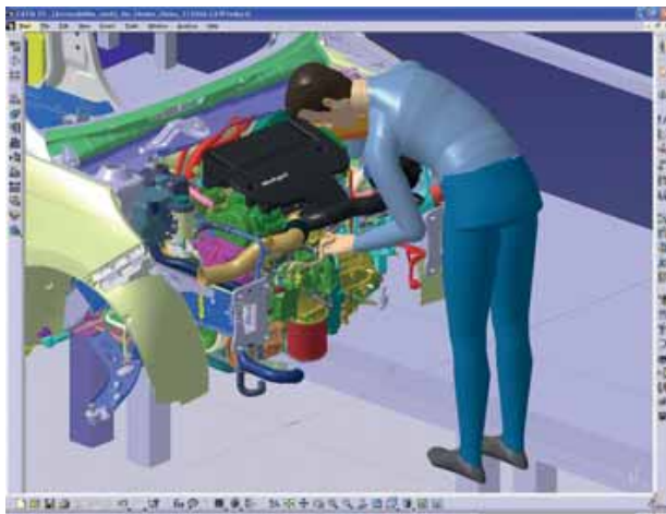
In het DELMIA-programma kan de complete autofabricage worden gesimuleerd. Daarmee kan de inrichting van de productieband worden bepaald en hoe werknemers aan die band zullen werken.
