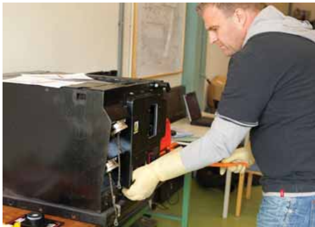
Dit betreft een serieus klusje, het openen van de kast waarin de hybridebatterij is ondergebracht om bijvoorbeeld het schakelrelais of de regelenheid te vervangen. Het pakket blijft namelijk altijd onder spanning.
