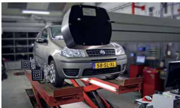
De LED's zenden signalen naar de spiegels, de spiegels reflecteren ze terug naar de camera's en die stuurt het naar de computer (rechts in beeld).
