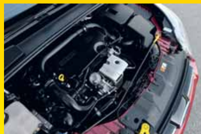
Het driepitter motorblok lijkt maar nauwelijks groter dan de turbo, met zijn eigen afdakje. Ford probeert niet het met een groot motordekseel erover meer te laten lijken dan het is.
