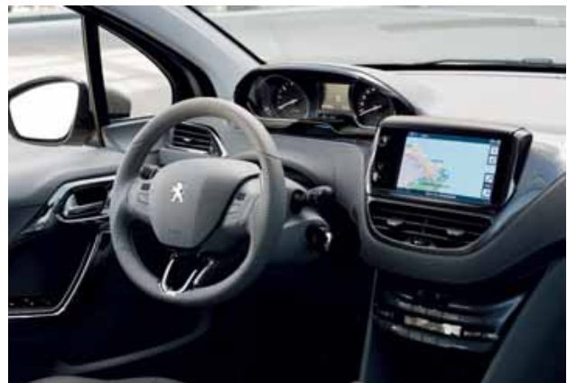
Het nieuwe bedieningsconcept van Peugeot, met hooggeplaatste meters en beeldscherm bovenop de middenconsole, vereist een opvallend klein stuurwielkje.
