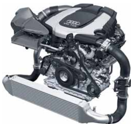
De Biturbo V6 TDI is een zeer compacte motor. Hij is zo kort mogelijk gebouwd en is slechts 437 mm lang. Dat er twee turbo's in en achter de V liggen, is niet te zien. We zien wel de forse inlaatluchtcooler, het luchtfilter en de motorafdekking. Een lange polysnaar slingert zich om zeven poelies.
