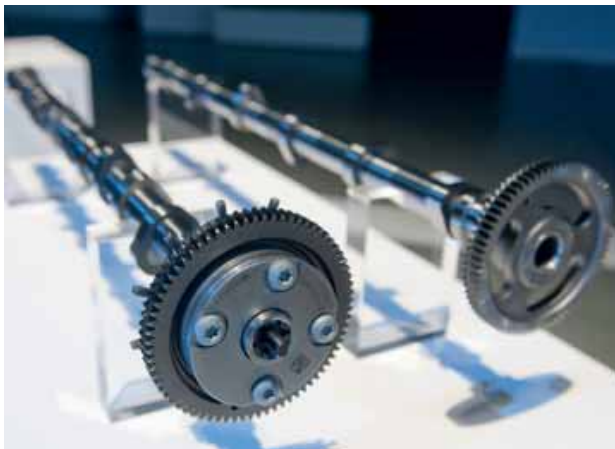
Het primeurtje van Mercedes; op de uitlaatnokkenas (vooraan) zit een verstelmecanisme.
