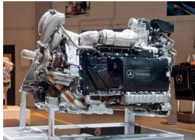
De OM 936 verschijnt ook in liggende versie voor onder de vloer van bussen, ondanks de dubbele nokkenas keurig laag gebouwd.
