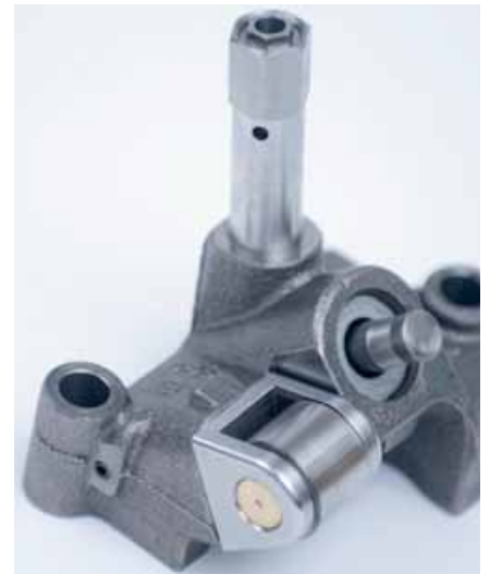
Ook op de kleinere motoren een motorrem, via dit onderdeel bij de uitlaatkleppen. Hij werkt in twee fasen, en heeft niet zoals bij de grote OM 471 nog een derde (tussen)fase waarin maar drie van de zes cilinders remwerking geven.
