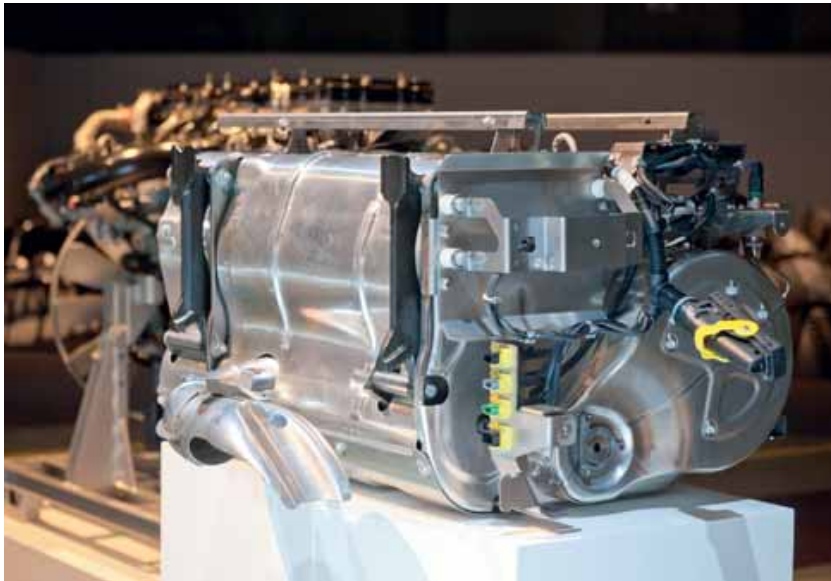
Ook bij Mercedes-Benz nu één kast met alle uitlaatgasreiniging. U ziet rechts de grote stekker hangen voor de afzonderlijke elektronica die dit regelt.
