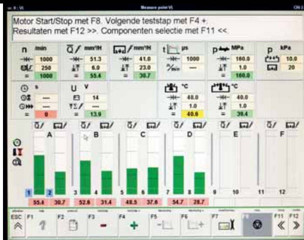
In deze test met vier verstuivers (A/B/C/D) ziet u wel dat ze allemaal verschillend presteren en dat verstuiver C wel erg ver achterblijft.
