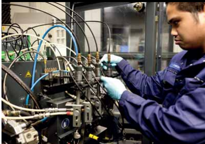
Met kostbare professionele testbanken kan Diesel Büchli inspuitingen van alle gevoerde merken testen. Zowel om gereviseerde delen te controleren als om diagnose te stellen in opdracht van klanten.
