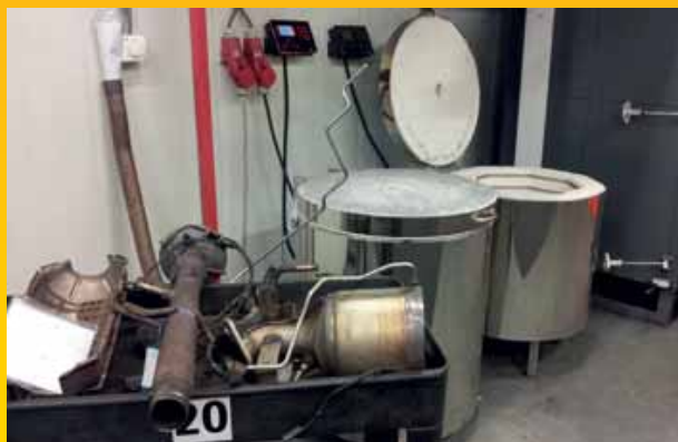
In de ovens op de achtergrond worden dichtgelopen roetfilters schoongebrend. Daarna blijft as over, die zoveel mogelijk uit het filter geblazen wordt, zodat het dan weer bijna helemaal schoon is.
