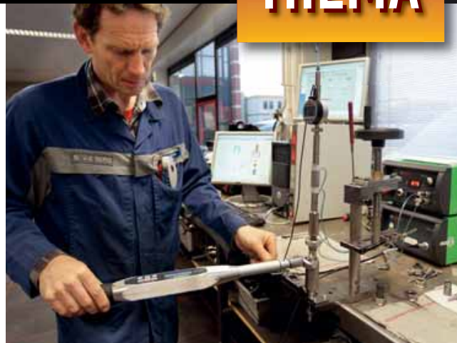
Bij fase 3 revisie wordt een verstuiver helemaal opnieuw opgebouwd. Een uiterst precies werkje met meetklok en momentsleutel bepaalt de exacte instelling van de verstuiver.
