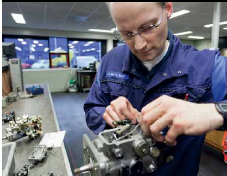
Een inspuitpomp wordt gecontroleerd op schade en defecten. Wordt het reparatie of revisie? Op de achtergrond ligt een gelijke, al gereviseerde pomp klaar.
