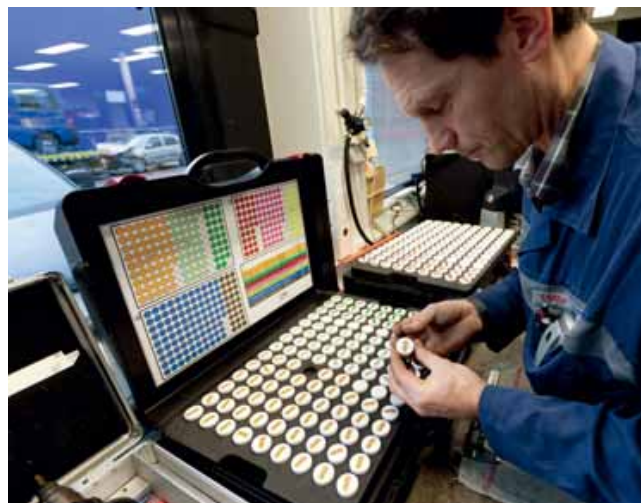
Om een verstuiver bij fase 3 revisie zo nauwkeurig mogelijk binnen de toleranties te laten werken is een heel regiment vulringetjes beschikbaar, met in enkele duizendsten van millimeters oplopende dikte.
